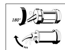
3. Coloque la cápsula de aplicación en el aplicador, gire en la dirección deseada y aplique el contenido en la cavidad o en la restauración que se desea fijar, apretando la palanca de manera lenta y uniforme. No ejerza demasiada presión.
