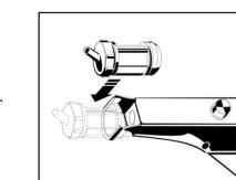
4. Après l'application, déplacer à nouveau le piston vers l'arrière en appuyant sur le bouton de déverrouillage et enlever la capsule par le haut.
