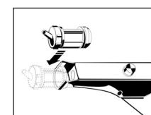
4. Después de la aplicación mueva el émbolo hacia atrás, apretando para ello el botón de desbloqueo y extraiga la cápsula de aplicación hacia arriba.
