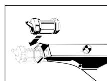
4. Nach der Applikation den Kolben wieder durch Drücken des Entriegelungsknopfes nach hinten bewegen und die Applikationskapsel nach oben herausnehmen.
