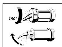
3. Applikationskapsel in den Applikator einlegen, in die gewünschte Richtung drehen und den Inhalt durch langsames, gleichmäßiges Zusammendrücken des Hebels in die Kavität oder in die zu befestigende Restauration applizieren. Nicht zu viel Pressdruck ausüben.
