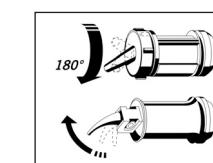
3. Placer la capsule d'application dans l'applicateur, m'tourner dans la direction voulue, et appliquer le contenu dans la cavité ou la restauration à sceller en appuyant lentement et de manière régulière sur le levier. Ne pas exercer de pression trop élevée.
