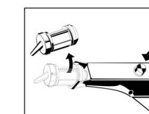
5. Dé sinfector l'applicateur Omnident C Applikator après utilisation. Pour cela, il est possible d'utiliser des chiffons de désinfection ou des solutions désinfectantes courantes. L'applicateur peut être stérilisé à la vapeur jusqu'à 134 °C max. (suivez les indications du fabricant pour l'autoclave).
