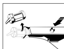
5. Nach Gebrauch den Applikator desinfizieren. Zur Desinfektion können handelsübliche desinfizierende Tücher und desinfizierende Lösungen verwendet werden. Der Omnident C Applikator ist geeignet zum Dampfsterilisieren bis max. 134 °C (Dampfsterilisationsgerät, Angaben des Herstellers beachten).
