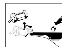
5. Desinfecte el aplicador después de su uso. Para la desinfección pueden utilizarse toallitas desinfectantes convencionales y soluciones desinfectantes. El Omnident C Applikator es apto para la esterilización por vapor hasta un máximo de 134°C (esterilizador por vapor, observe las indicaciones del fabricante).
